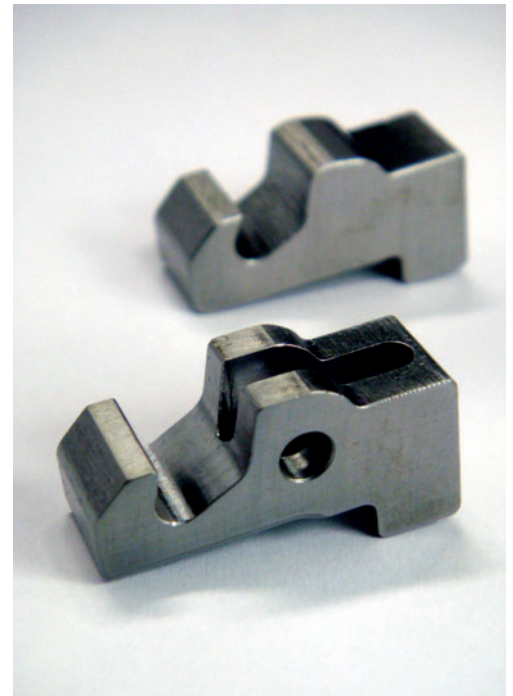
Zur Arbeit bereit: Funktionskomponente aus Vergütungsstahl Ck 45 als Rohteil (hinten) und als Fertigteil, kostengünstig getrennt vom Präzisionsprofil
